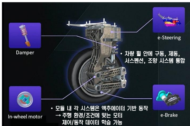
현대모비스 e-Corner 모듈 - X-by-Wire 형태 전자식 메커니즘
