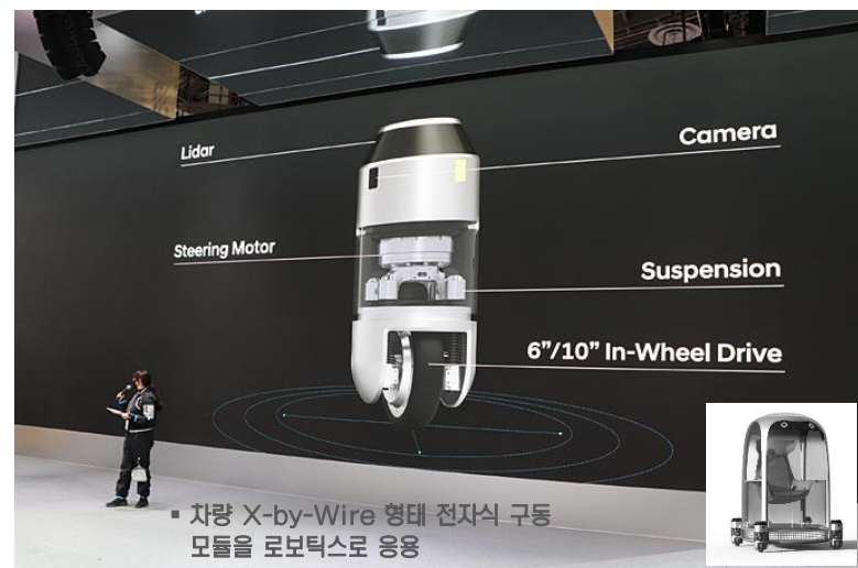
현대차 로보틱스랩 로봇 드라이브 모듈(PnD)- 제어/동작 데이터 생성 및 학습
