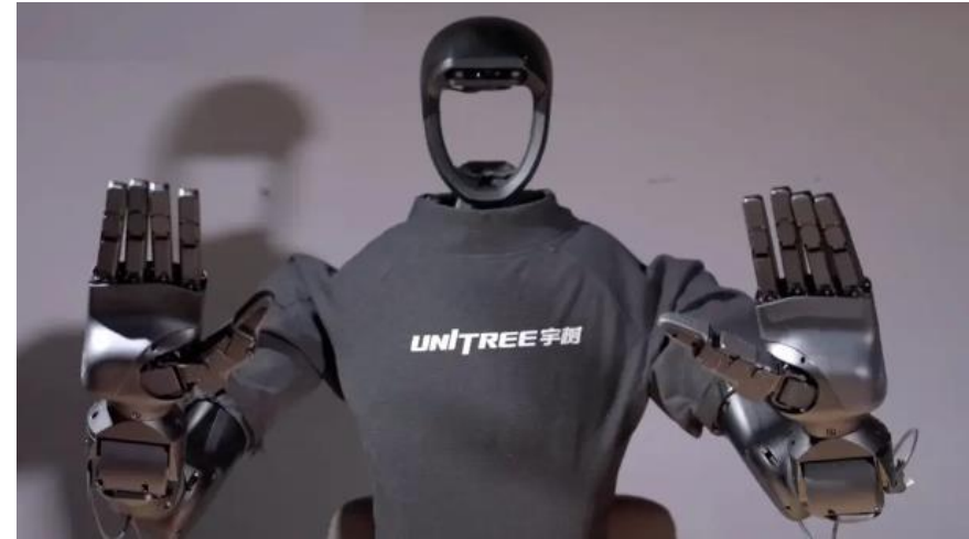
<그림46> 로봇틱스의 액추에이터가 탑재된 것으로 확인되는 Unitree Robotics의 덱스트러스
