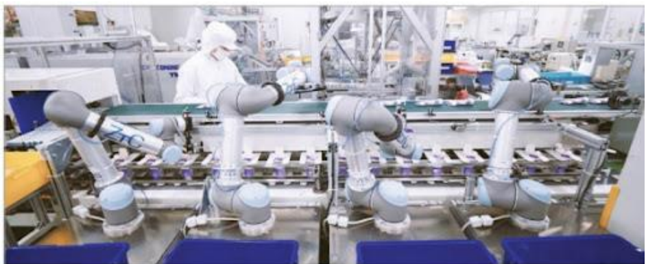
그림 25. 제조업 공정에 사용되는 협동로봇
