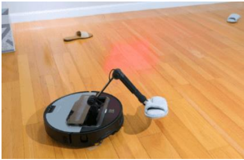
그림 4. Lidar를 사용하는 로봇청소기
