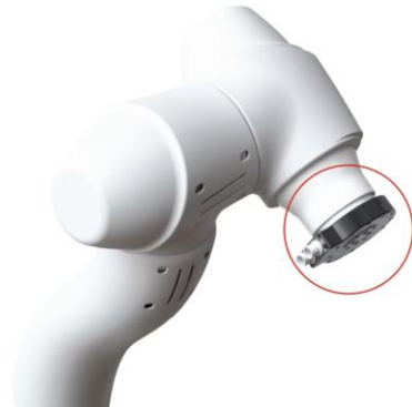
그림 24. 6축 관절에 적용된 힘/토크센서
