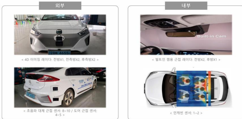
그림 46. 차량용 (AD/ADAS) 레이더 제품 구성
