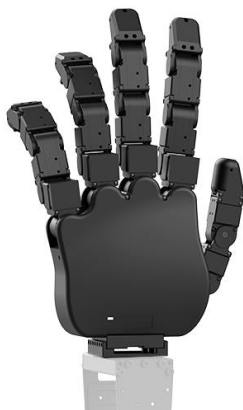
[그림26] Multi-finger - 로보티즈 HX-5 (20 DOF)
