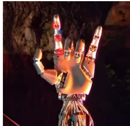
그림11. 최근 Tesla Optimus 텍스트러스: 22 DoF (액츄에이터)로 구성됨
