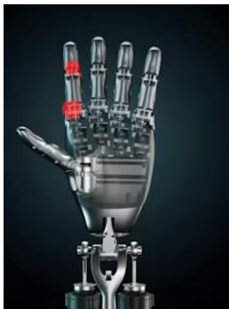
그림10. 기존 Tesla Optimus 텍스트러스: 11 DoF (액츄에이터)로 구성됨
