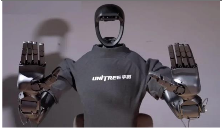
그림7. 로보티즈의 액츄에이터가 탑재된 것으로 확인되는 Unitree Robotics의 텍스트러스
