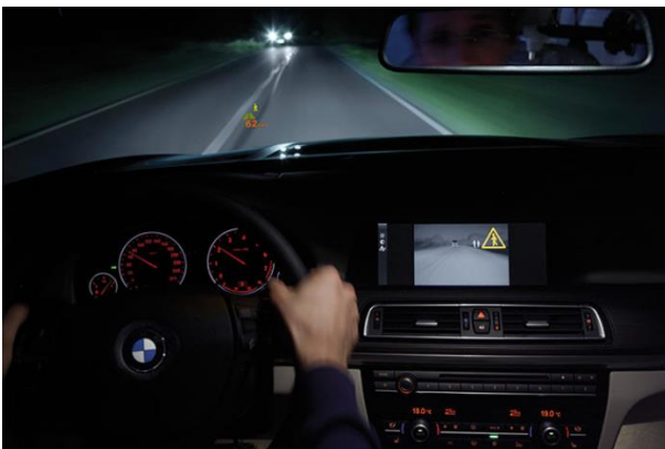
[그림5] IR 센서를 활용한 BMW Night Vision 시스템
