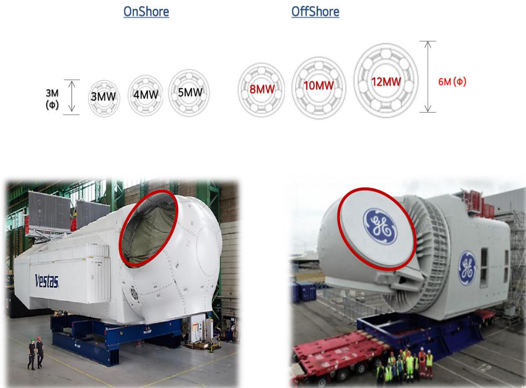
그림37. Pitch(Blade) Bearing Size
