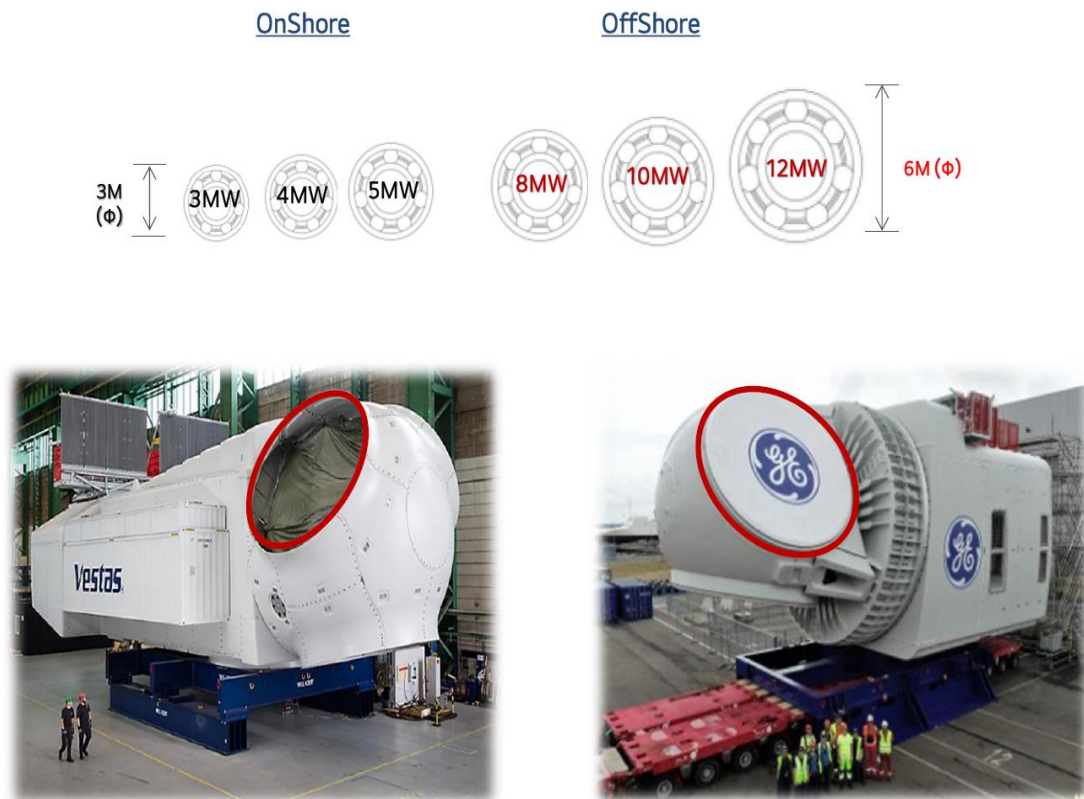
그림33. Pitch(Blade) Bearing Size
