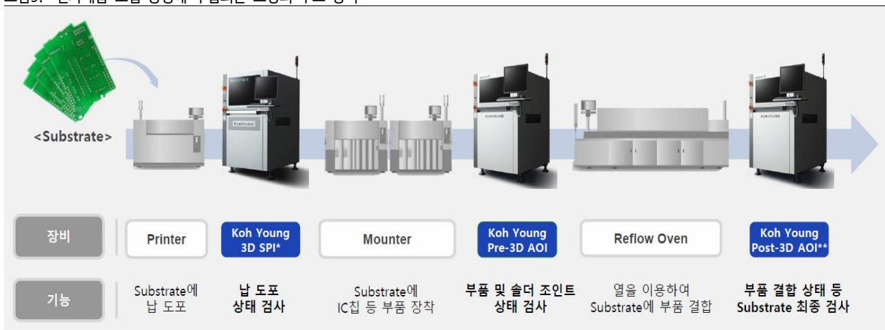
그림9. 전자제품 조립 공정에 투입되는 고영의 주요 장비
