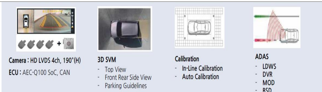
그림49. 쉼트로닉스 SVM(Surround View Monitoring) 구성 및 기능
