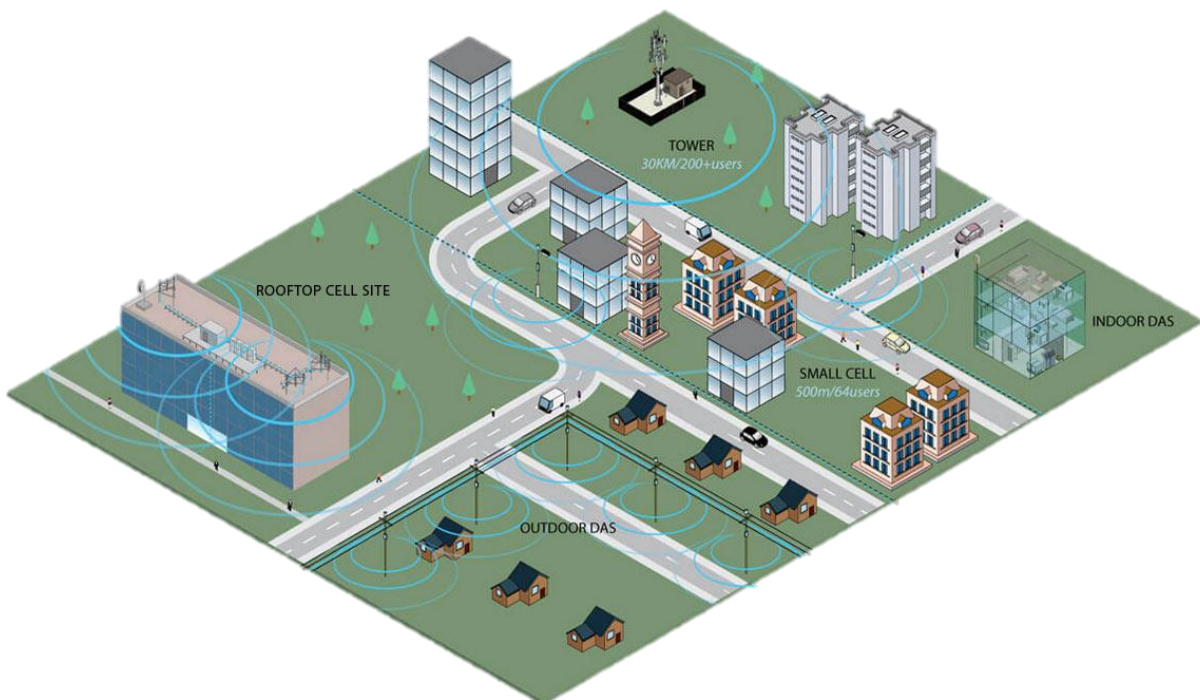
그림10. 기지국은 Cell tower, Rooftop Cell Site 등 방식으로 구축
