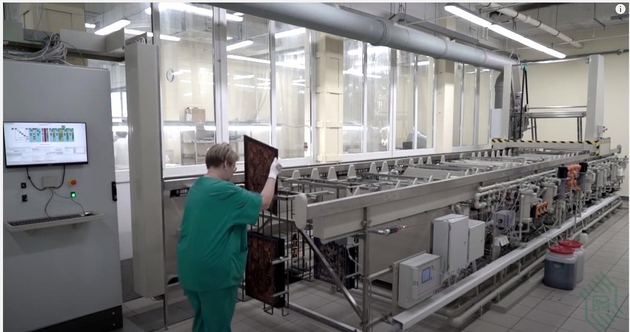
그림7. ENEPIG(Electroless Nickel Electroless Palladium Immersion Gold) 공정 라인
