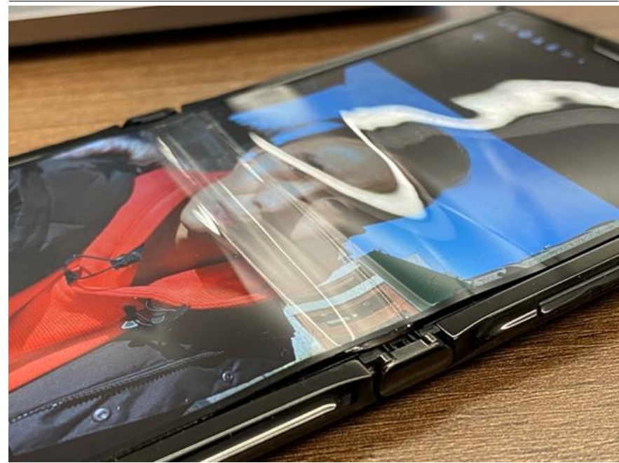
그림31. Motorola RAZR(Foldable) - Cover window가 들뜨는 불량 발생
