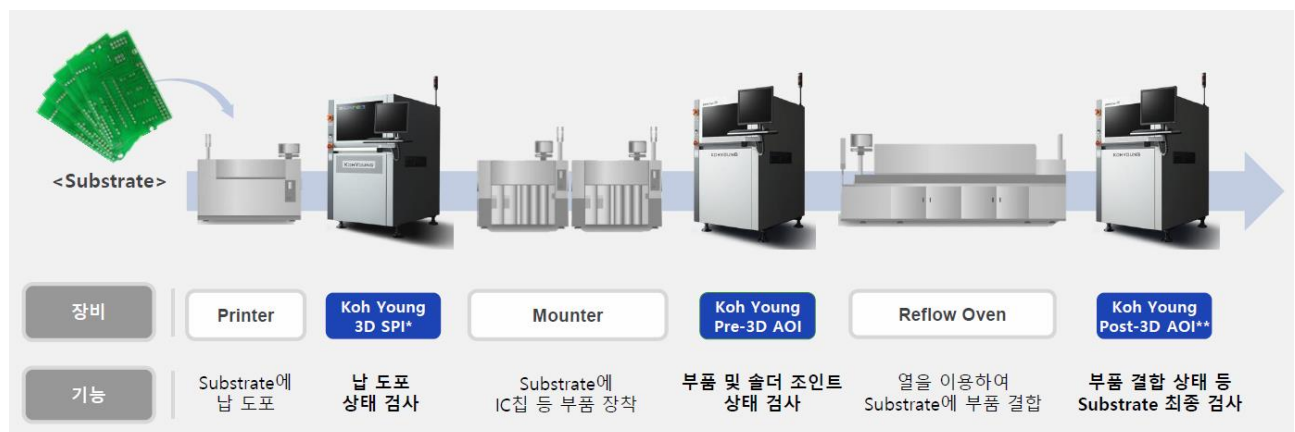
그림38. 전자제품 조립 공정에 투입되는 고영의 주요 장비
