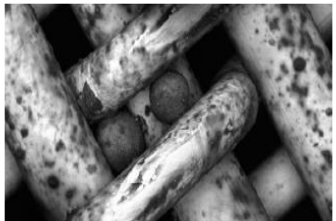
그림 69. Cat fines entrapped in the mesh of a fuel filter
