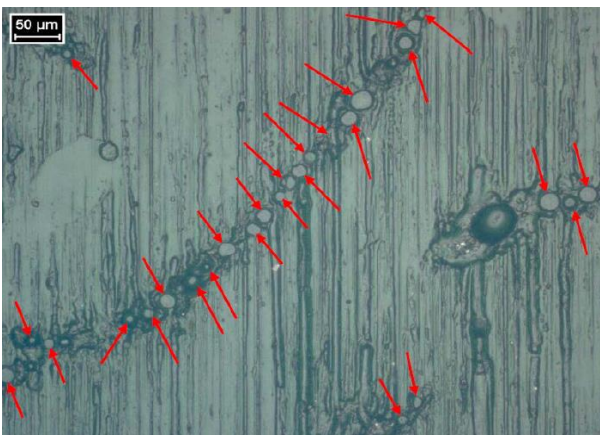
그림 68. Red arrows show cat fines embedded in cylinder liner
