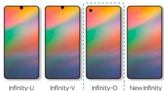
그림 2. 식각: HIAA(Hole in active area)
