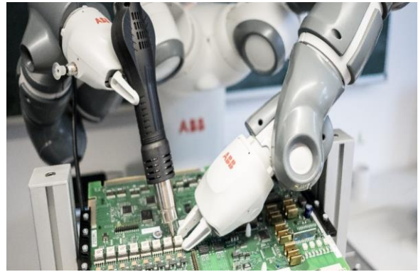
그림 29. 양팔을 이용해 납땜 용접 작업중인 YuMi
