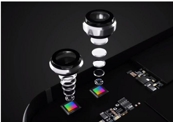
그림1. 기존 '카툰' 현상의 주요 원인인 상하 적층 방식
