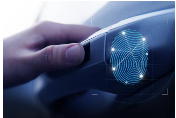
그림 4. 생체인증 기술로 차량 열쇠없이 도어 개폐와 시동이 가능해짐
