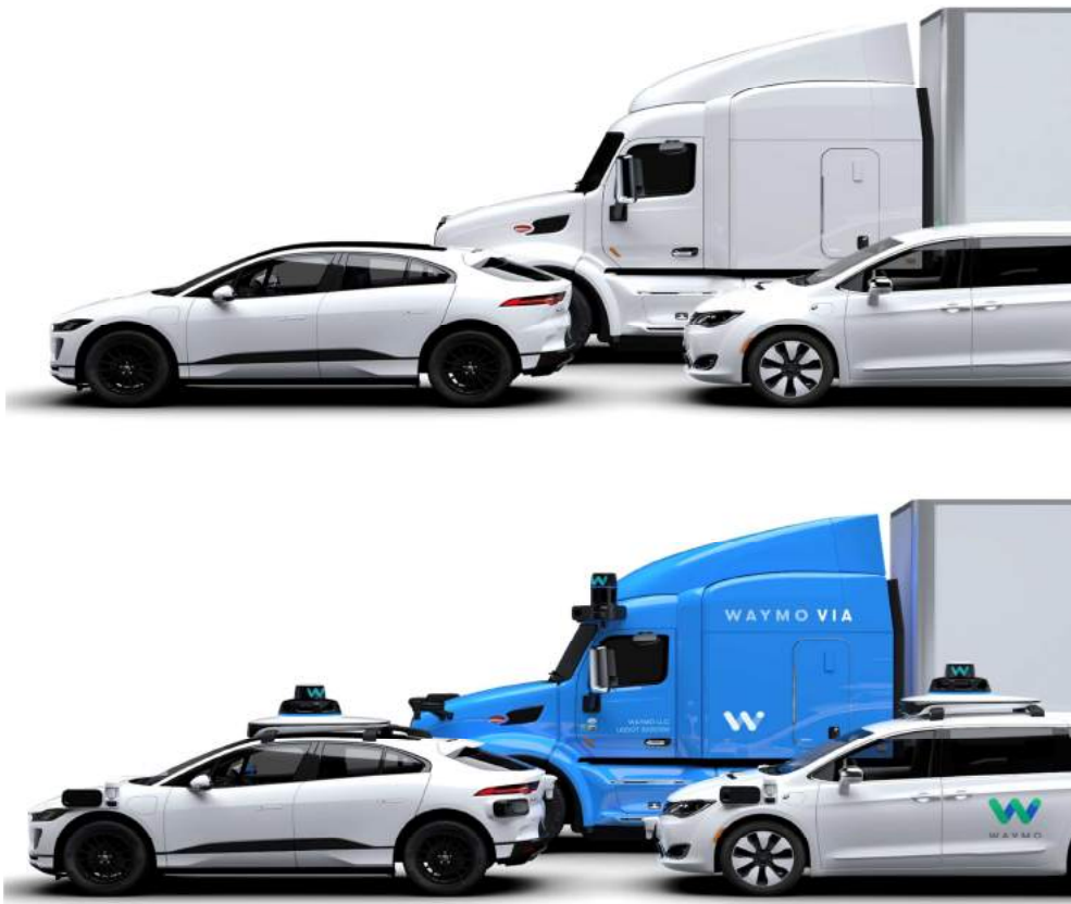
그림34 웨이모 자율주행 플랫폼 적용 전후 자동차
