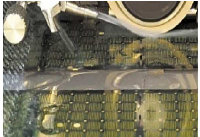
그림134 반도체 기판 Singulation 공정 이미지
