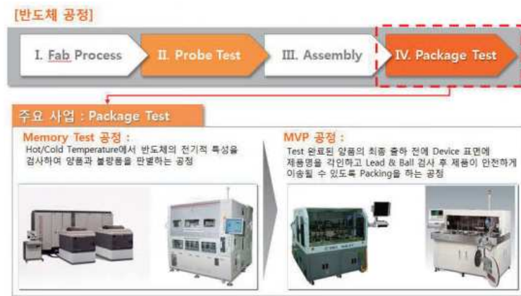
그림68 하이셀 주요 공정: 메모리 Pkg 테스트
