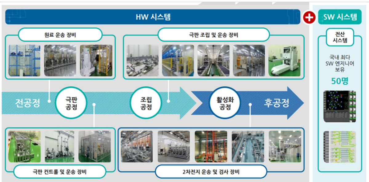
도표 22. 2 차전지 공정 내 자동화 장비 및 제어를 총괄하는 시스템 솔루션 제공
