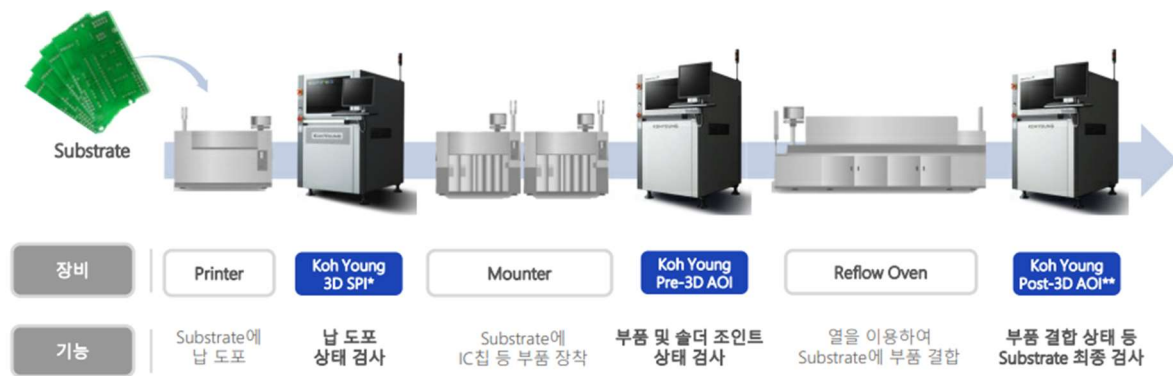
도표 7. 사업 영역: 전자제품 조립 공정에 투입되는 고영의 주요 장비
