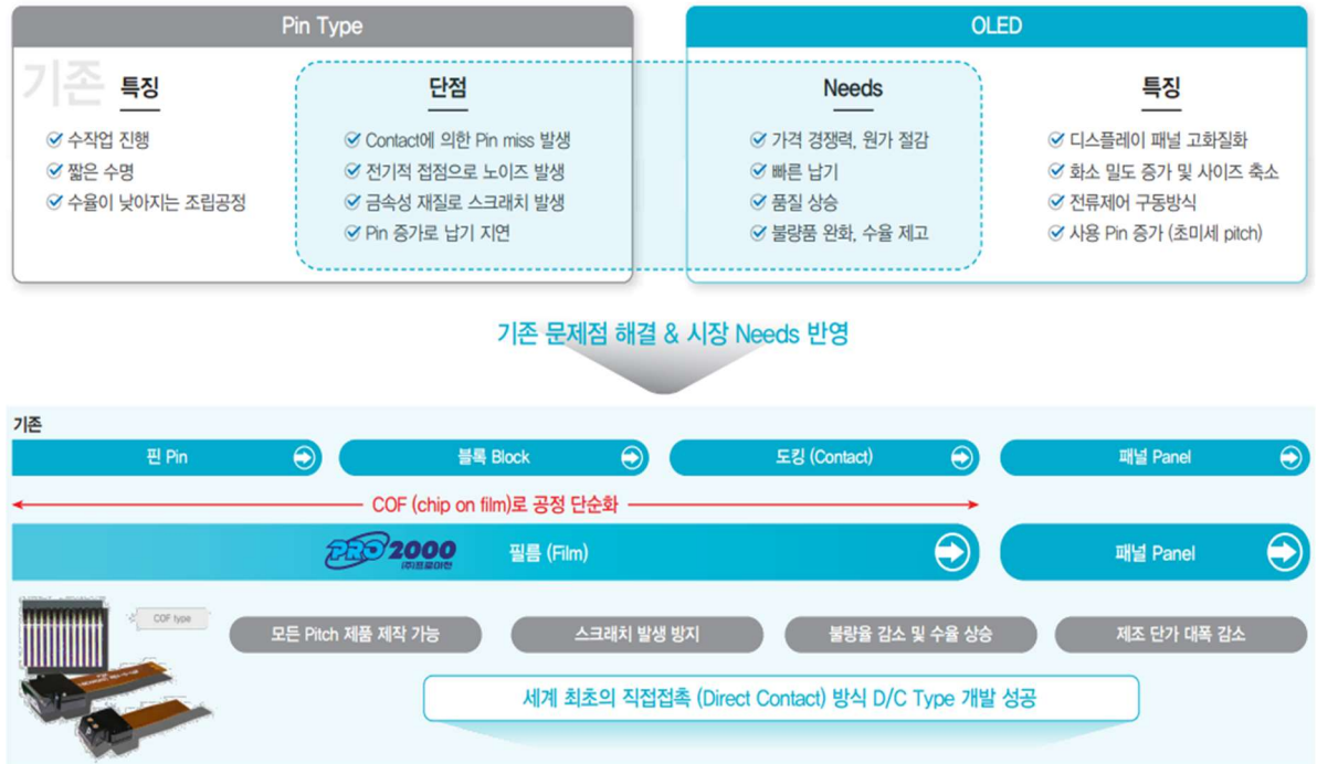
도표 11. 핵심원천기술: D/C 기술을 세계 최초로 적용한 디스플레이 검사장치 개발
