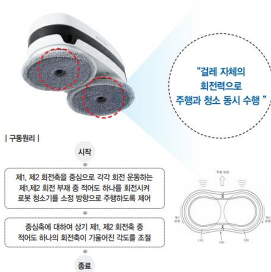
도표 18. 주요기술: 바퀴 없는 로봇청소기의 주행을 정확하게 제어하는 로보스핀 기술
