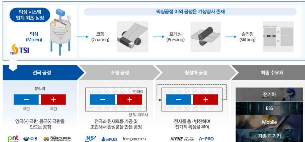
도표 88 사업 영역: 2 차전지 전극 공정 내 믹싱시스템 제조 및 설치
