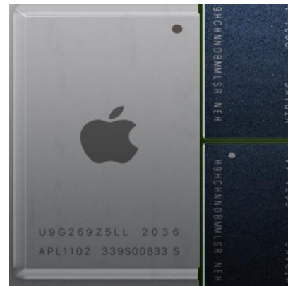
Apple M1 칩 패키지 (Heat Slug 적용 예시)
