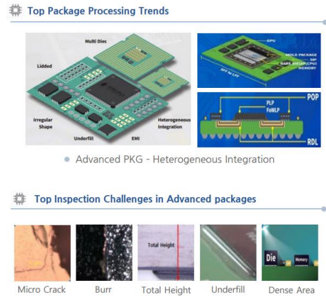
그림2 인텍플러스 검사 항목 - 첨단패키징 외관 검사 수행
