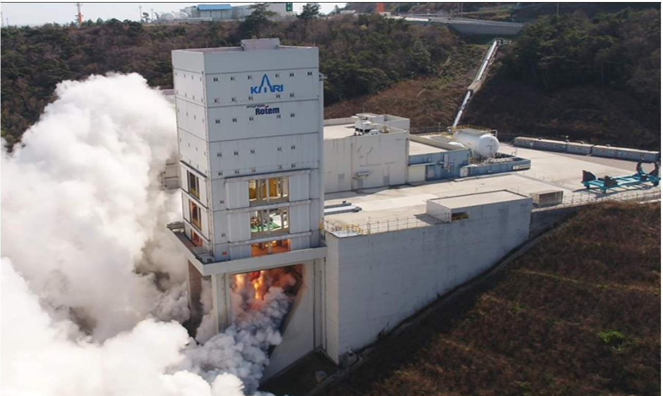
그림14. 현대로템이 구축한 한국형발사체 추진기관시스템 시험설비
