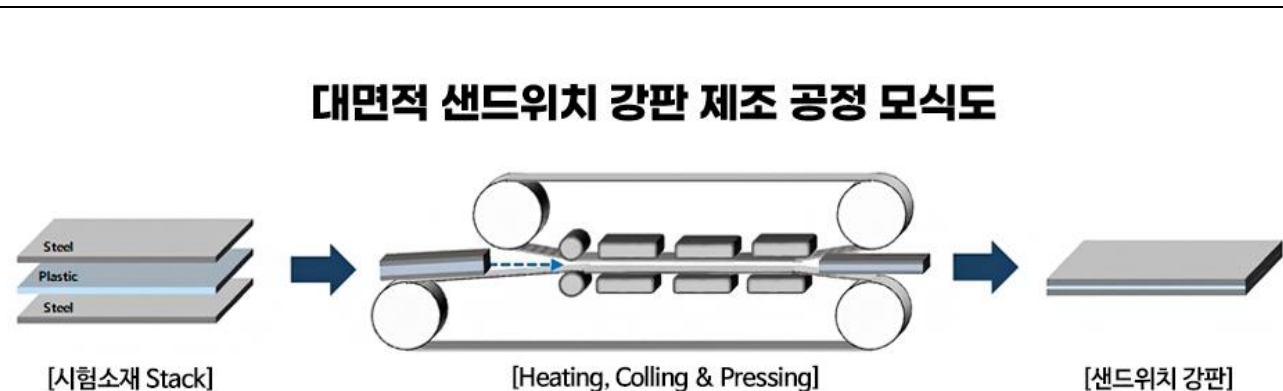
그림18. 강판과 강판 사이에 플라스틱 시트를 삽입하여 만들어지는 샌드위치 강판
