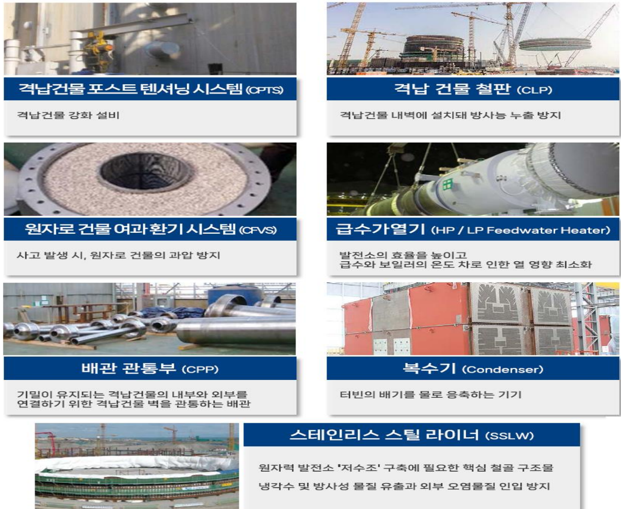
그림10. 원자력 발전 관련 비에이치아이 BOP 주요 제품
