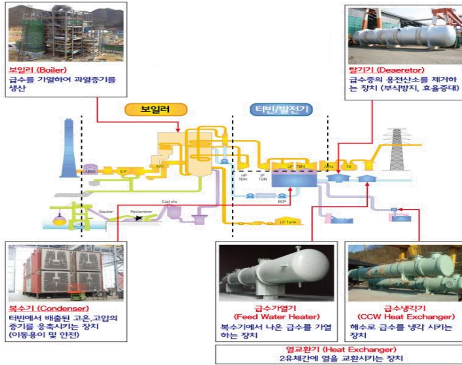
그림16. 화력 발전과정 및 비에이치아이 주요 제품
