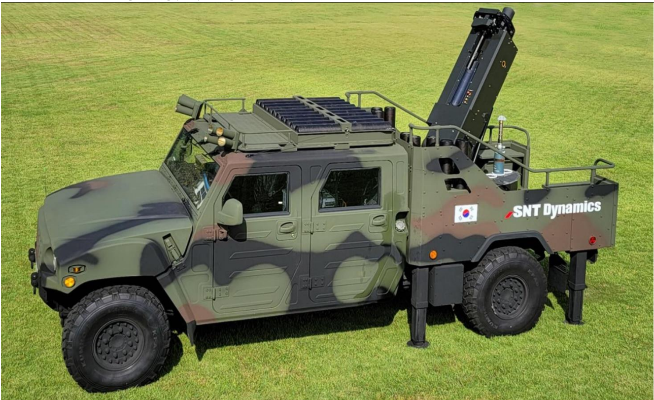
그림11. SNT 다이내믹스 소형전술차량(LTV) 탑재형 120mm 박격포체계
