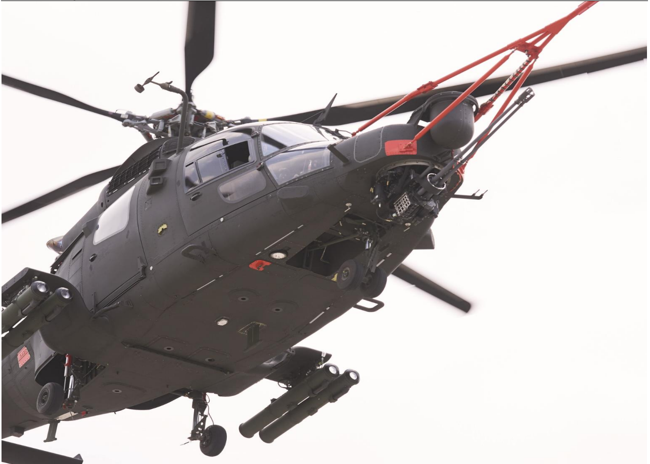
그림12. LAH(Light Armed Helicopter)에 부착된 터렛형 기관총 시스템(TGS)
