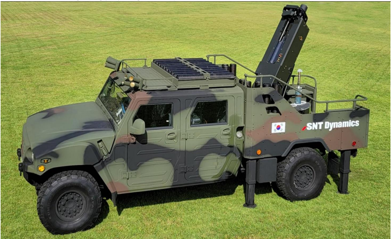
그림11. SNT 다이내믹스 소형전술차량(LTV) 탑재형 120mm 박격포체계
