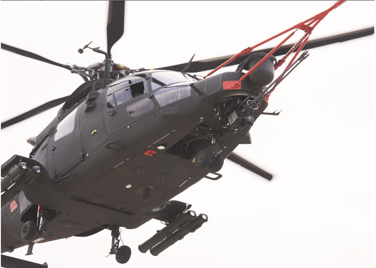
그림10.LAH(Light Armed Helicopter)에 부착된 터렛형 기관총 시스템(TGS)
