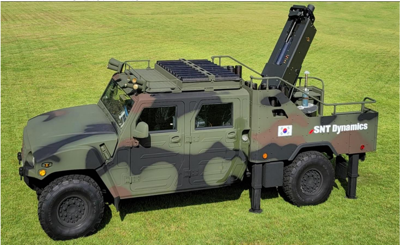
그림9.SNT 다이내믹스 소형전술차량(LTV) 탑재형 120mm 박격포체계
