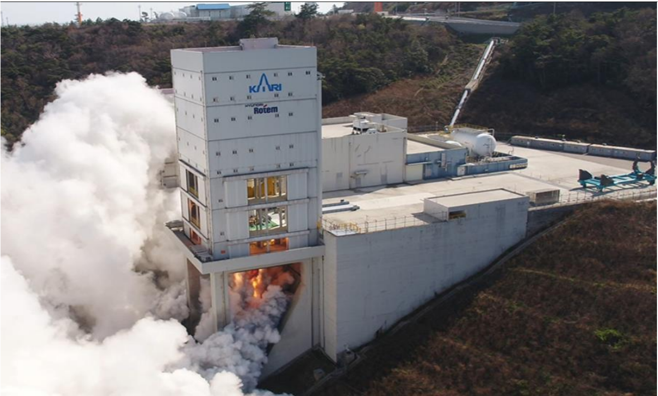
그림11.현대로템이 구축한 한국형발사체 추진기관시스템 시험설비
