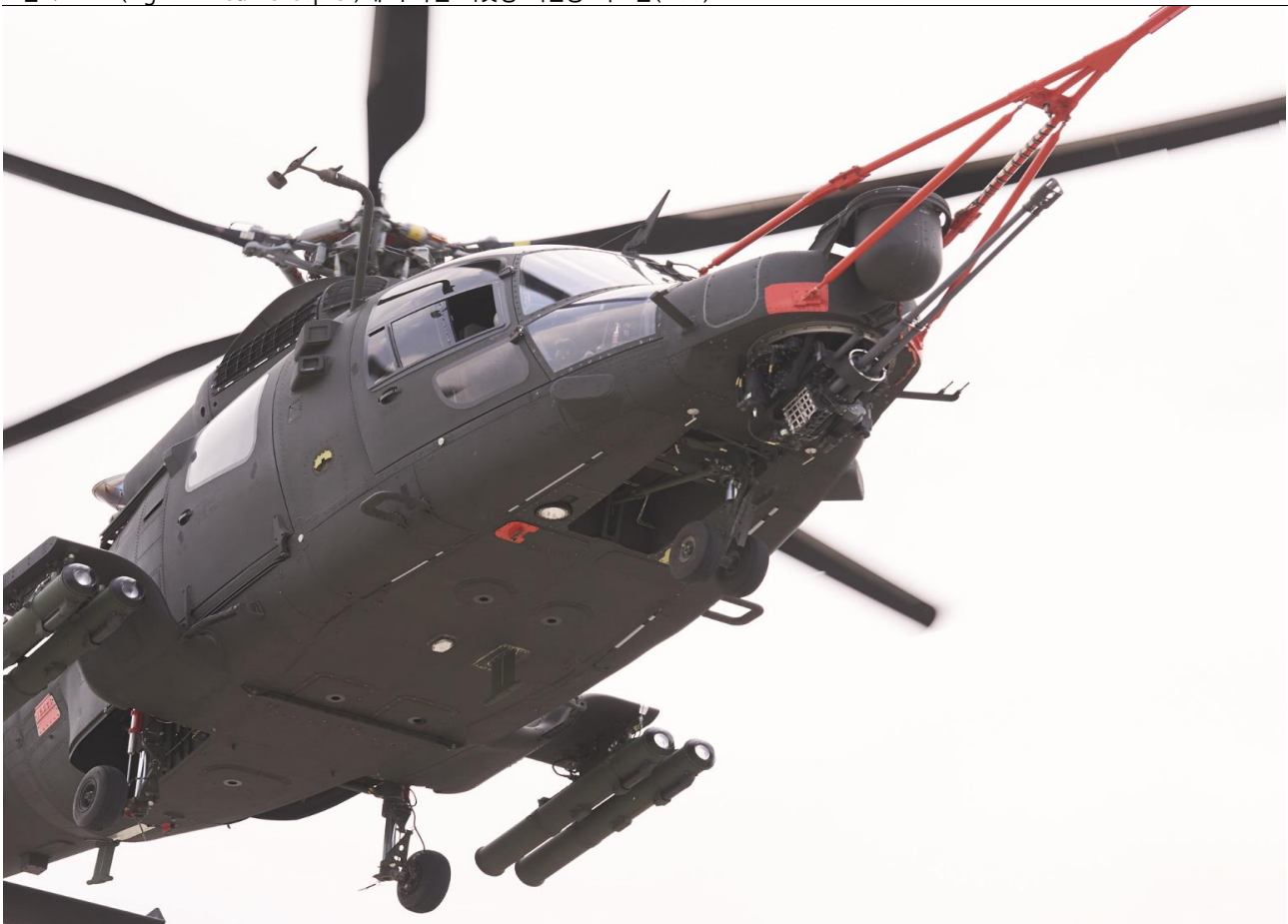
그림7. LAH(Light Armed Helicopter)에 부착된 터렛형 기관총 시스템(TGS)
