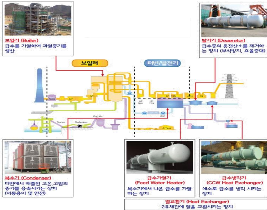
그림16. 화력 발전과정 및 비에이치아이 주요 제품
