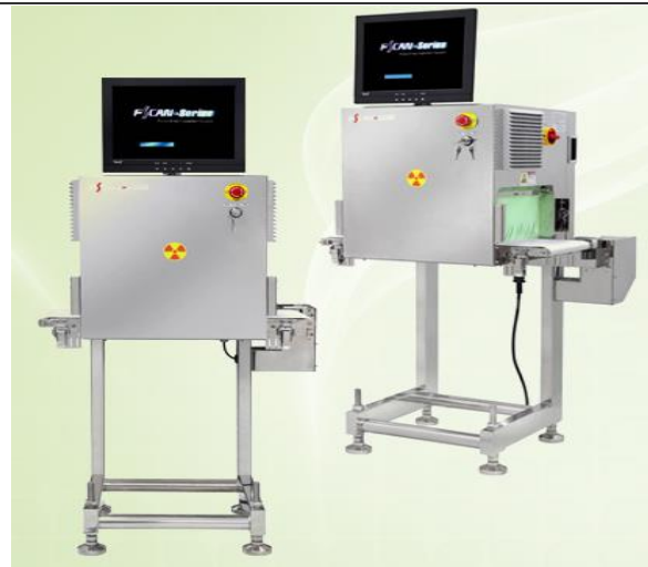
그림 2. Fscan-3080L: 자동화기술을 통한 식품 이물 검출기
