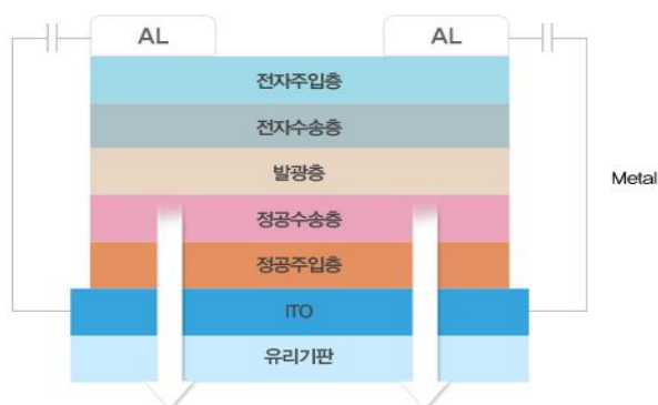
그림 3. OLED Cell의 구조 단면도
