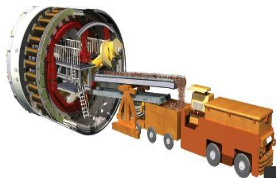
그림 23. TBM 후면, 굴착으로 생긴 부산물 폐기
