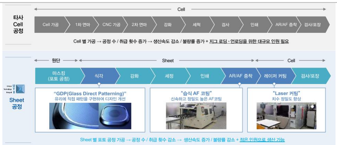
도표 48. 유티아이의 Sheet 생산 공정과 타사의 Cell 공정 비교
