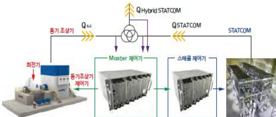
그림 13. 효성중공업의 Hybrid STATCOM(동기조상기와 스태콤을 결합한 무효전력+관성 솔루션) 구성도
