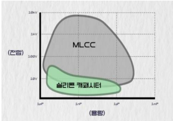
그림3 실리콘 캐패시터는 낮은 전압, 고용량이 영역을 담당
