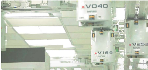
반도체 생산 라인 內 OHT 1 (Over Head Transport)
