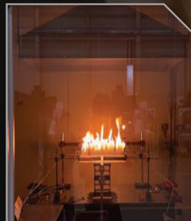
배터리 시스템 내화시험
