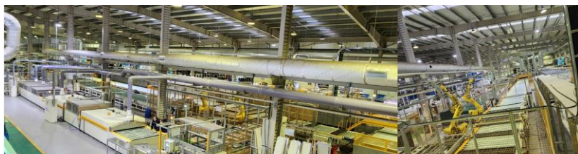
국내 최대 규모의 EV / ESS Cooling Plate 브레이징 라인
