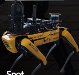
Spot 건설현장 데이터 자동기록용 SPOT 장착 장비
