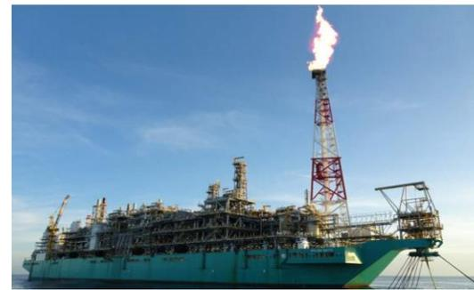
부유식 LNG 생산설비 (FLNG : Floating LNG)
