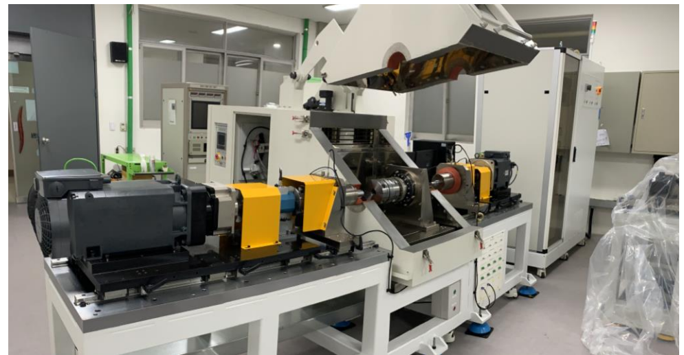
고정밀 감속기 성능 측정 및 분석 로봇용 시험장비
